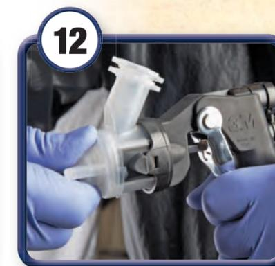
Attaccare nuovamente la stessa testa di spruzzatura o sostituirla se necessario.
