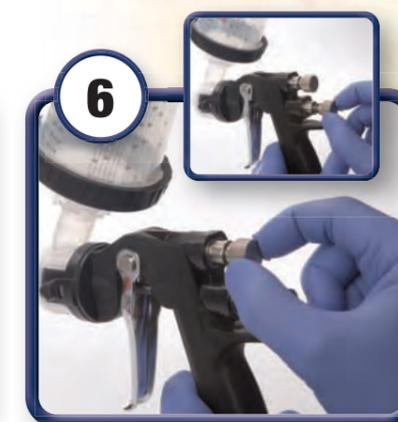
Regola il ventaglio ed il prodotto per ottenere la spruzzatura ottimale. **NOTA BENE:** una volta chiuso completamente il ventaglio può essere necessario regolare nuovamente la pressione.
