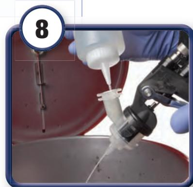
Pulire la testa di spruzzatura con il solvente fino a che tutto il fondo sia stato completamente rimosso. Non pulire in lavapistole automatiche. Pulire il corpo pistola con un panno imbevuto di solvente.
